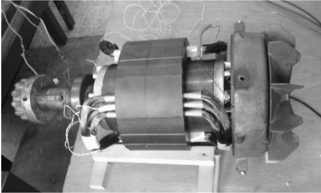
Fig. IV- 7 : photo des bobines, capteurs et un rotor dans le stator.
