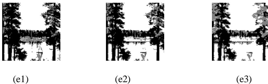
Fig. 4.9 : Image Lac segmentée par seuillage d'histogrammes basé sur le PSO. (a) : Kapur, (b) : Otsu, (c) : Renyi, (d):Shannon, (e): Tsallis. (1) : monodimensionnel, (2) : bidimensionnel, (3) : tridimensionnel
