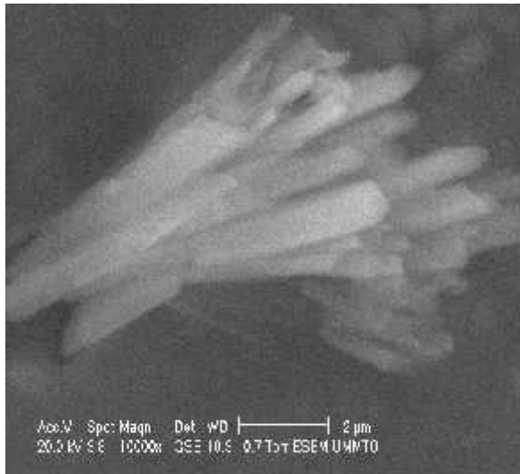
Figure II-10: Images MEB du mélange 20ml d'extrait d'algues+ 10ml de sel + 70ml d'eau distillée chauffé pendant 1h
