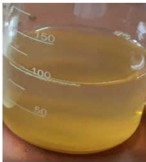
Figure II-2: Couleurs du mélange 10ml d'extrait d'algues+ 10ml de sel + 80 ml d'eau distillée avant et après chauffage
